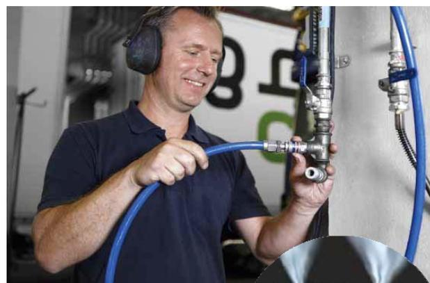
**Funzione anti frusta** – eSafe scarica l'aria in pressione a valle prima dello scollegamento, riducendo il livello di rumorosità ed eliminando il rischio di lesioni all'operatore.
