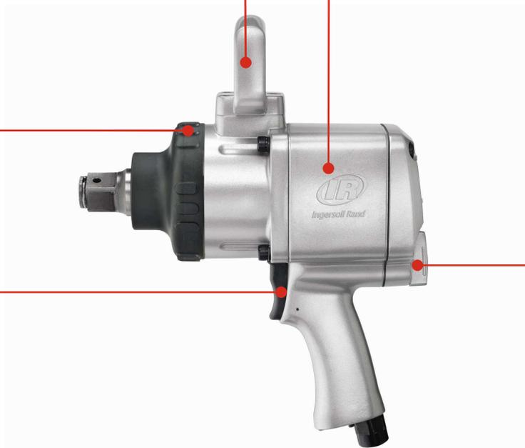
La serie di avvitatori 285B e 295A combina potenza, controllo e resistenza. Genera una coppia massima di 2 400 Nm ad una pressione di 8.3 bar, con una velocità libera di 5 250 giri al minuto ed un motore altamente efficiente a 6 palette.
