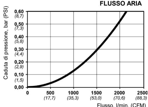
Portata flusso misurata con pressione di ingresso a 6 bar (87 PSI) e per caduta di pressione a 0.5 bar (7 PSI)
