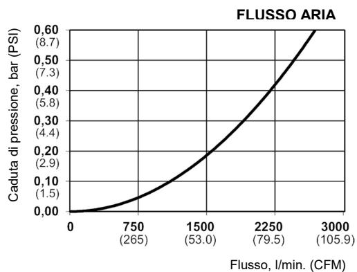
Portata flusso misurata con pressione di ingresso a 6 bar (87 PSI) e per caduta di pressione a 0.5 bar (7 PSI)
