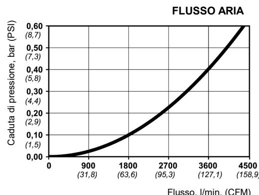
Portata flusso misurata con pressione di ingresso a 6 bar (87 PSI) e per caduta di pressione a 0.5 bar (7 PSI)
